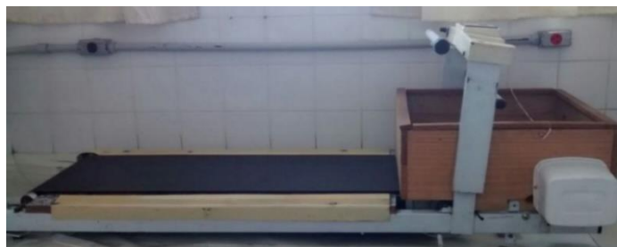
Figura 1 - Esteira elétrica adaptada para pequenos animais.
