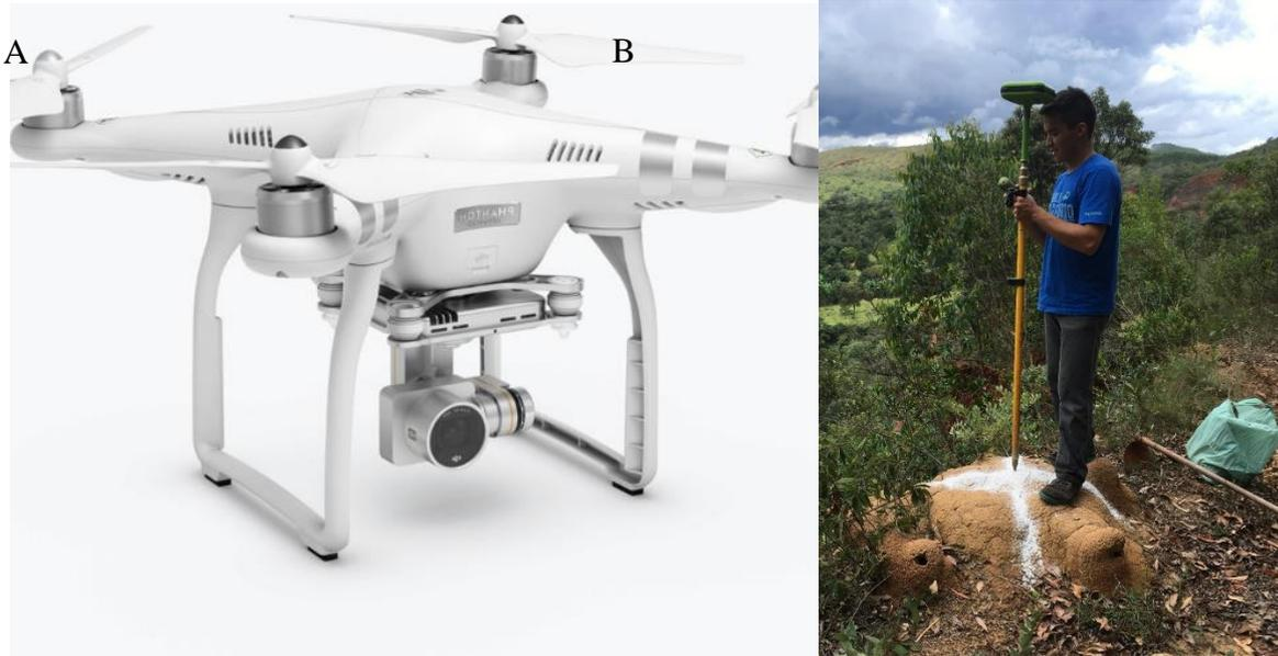
**Figura 3** – A)-Drone Phantom 3 Advanced (Fonte: DJI Technology); B) Coleta de pontos de controle com GPS RTK.
