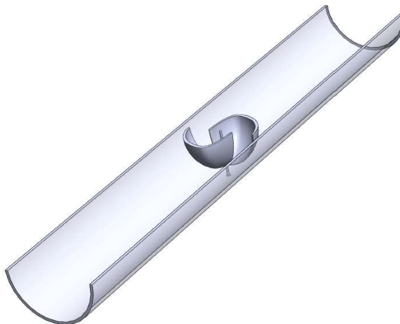
Figura 22 – Vista em corte da turbina GSC no interior de uma tubulação
