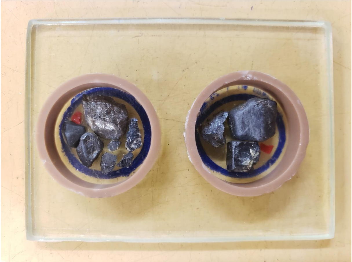
Figura 2.1 - Anéis, amostras e marcadores colados sobre adesivo antes da etapa de adição de resina (Fonte: autor).
