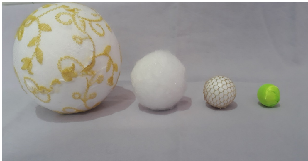
Figura 9: Bolas de isopor com diâmetros de 100mm, 50mm, 35mm e 20mm. revestidas por tecidos.
