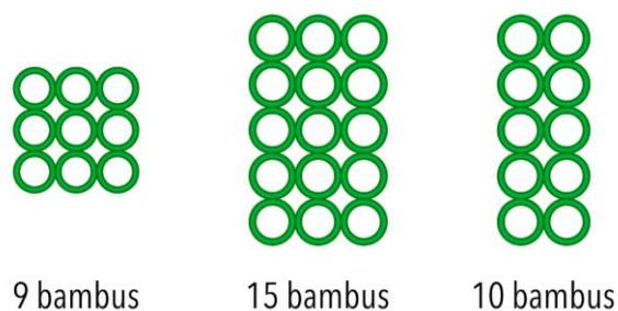
Figura 51 – Seções transversais consideradas no pré-dimensionamento
