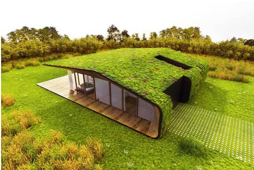
Figura 23 – Esquema de telhado verde, técnica que ajuda no aumento das áreas permeáveis e redução das ilhas de calor (Disponível em < https://www.inovagreen.com.br/telhadoverde.html >
