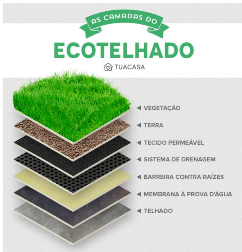
Figura 24 – Esquema das camadas componentes do telhado verde (Disponível em < https://www.tuacasa.com.br/telhado-verde/ > Acesso em set. 2019)
