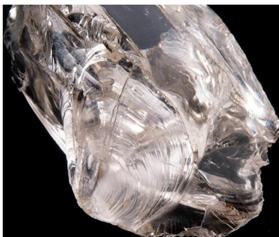
**Fig. 4.2** – Fratura conchoidal em cristal de quartzo (extraído de Klein & Philpotts 2013).
