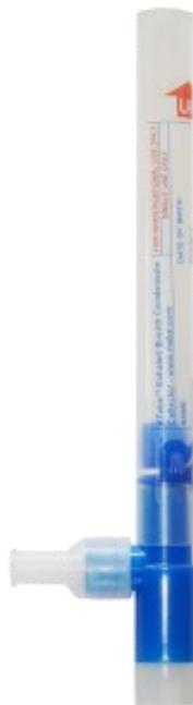
**Fig. 2.3** – Tubo plástico utilizado para coleta dos EBCs (RTubes®/ Respiratory Research Inc.).
