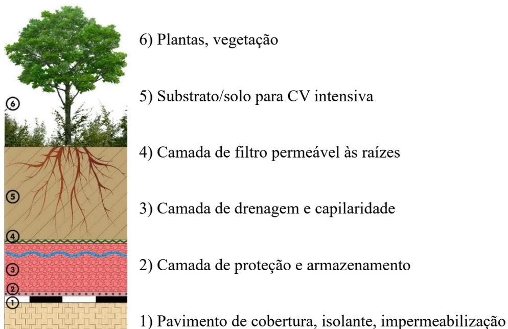
Figura 17: Camadas do sistema de cobertura intensiva
