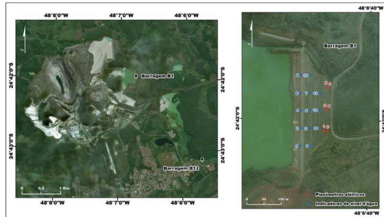
Figura 25: Localização da Barragem B1, destaque para a localização dos indicadores de nível de água em azul e piezômetros em vermelho
