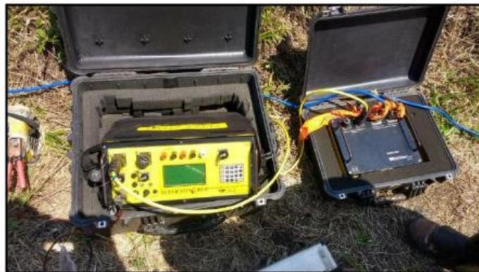
Figura 23: Resistímetro SuperSting utilizado
