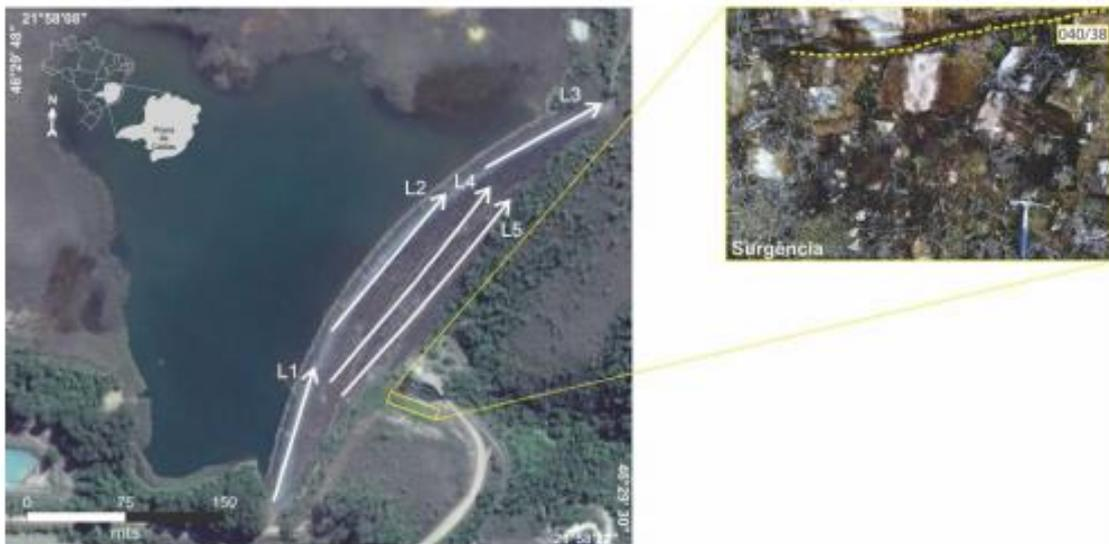
Figura 16: Vista aérea da barragem com indicação das linhas geofísicas, detalhe para a surgência observada a jusante
