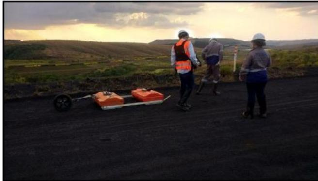
Figura 24: Aquisição de dados por GPR
