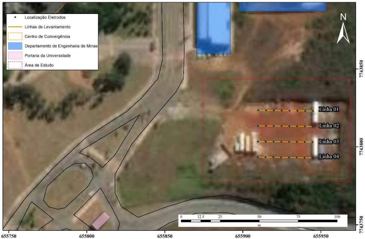
Figura 6.5 – Alocação espacial das linhas levantamento geofísico. Datum horizontal SIRGAS 2000. Imagem de satélite Basemap ESRI, shapefile de uso e ocupação do solo da cidade de Ouro Preto, Agência Nacional de Águas e Saneamento Básico (ANA 2020).
