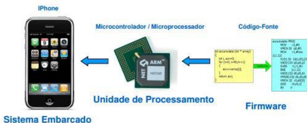
Figura 2 – Lógica de um sistema embarcado Fonte: GERVINI, 2003
