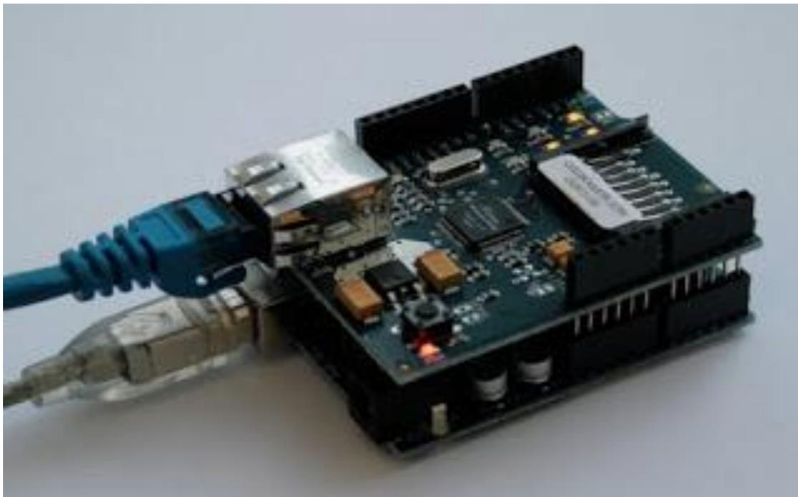
*Figura 2.11 – Acoplamento do shield no Arduino. Fonte: ARDUINO,2016.*
