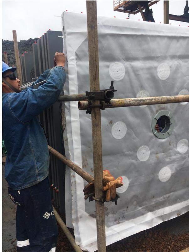
Figura 4 – Tecido de uma placa de filtro prensa em uma mineração do Quadrilátero Ferrífero
