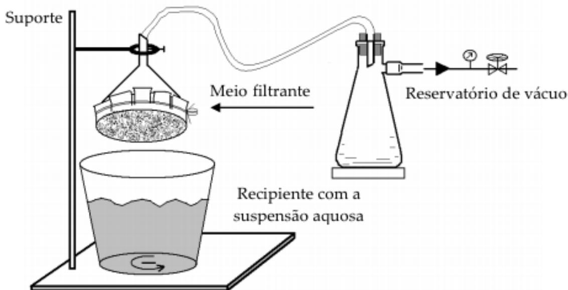
Figura 8 – Representação do aparato de *Leaf test*.
