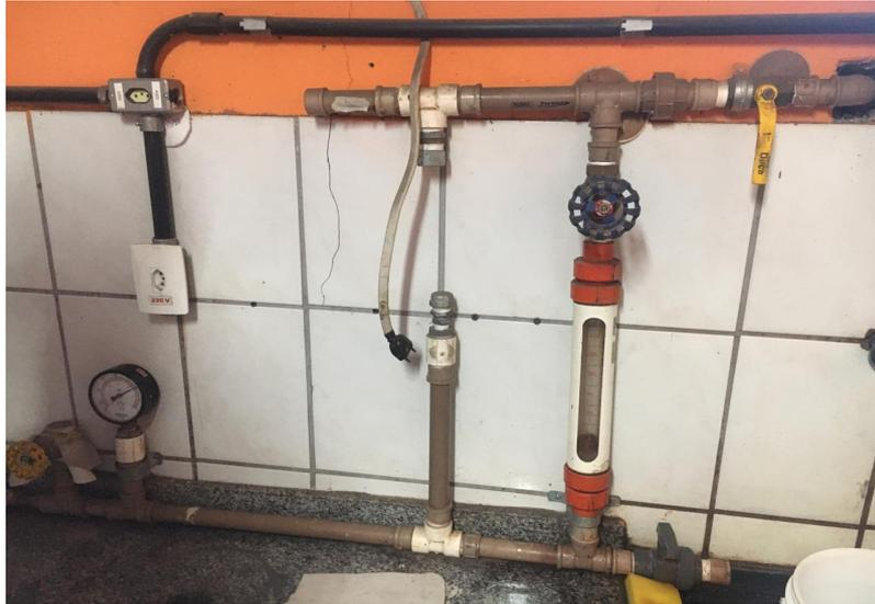
Figura 11 – Foto de parte do sistema de vácuo do *leaf test* utilizado nos ensaios.
