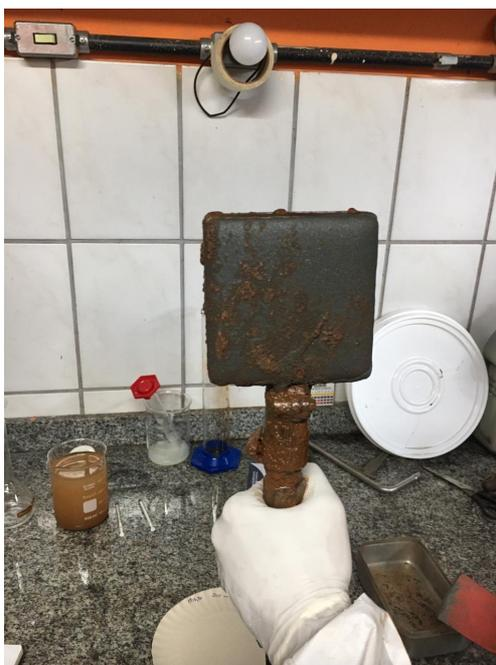
Figura 12 – Foto de uma torta formada sobre o meio filtrante utilizado nos testes.
