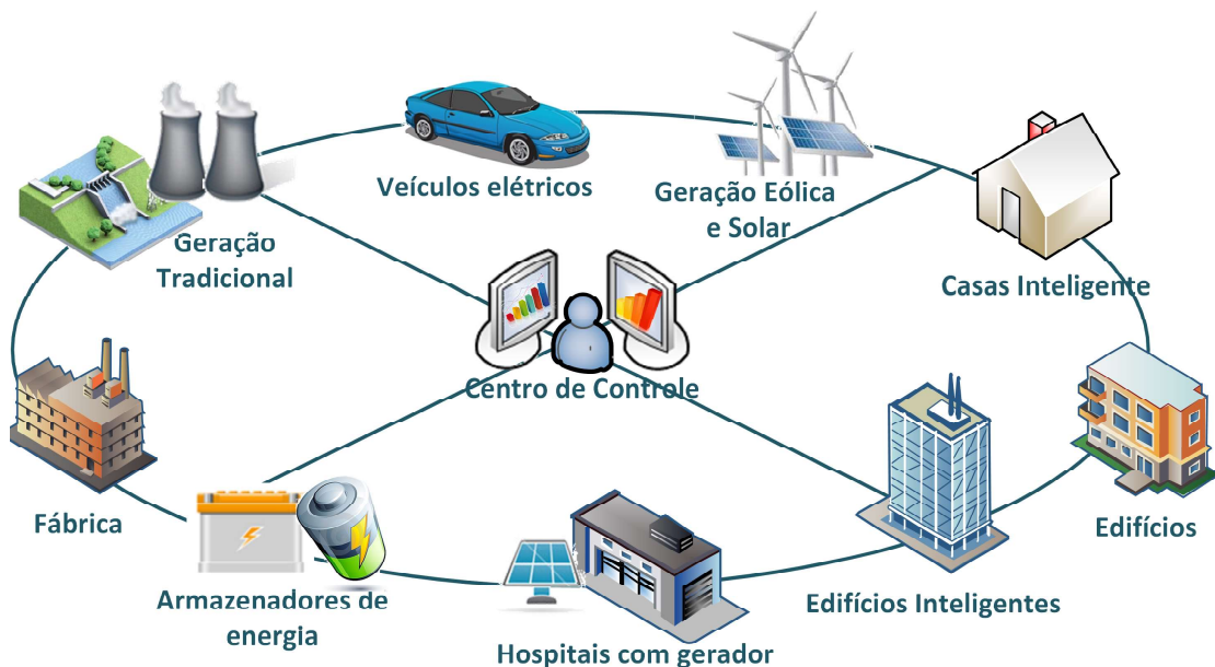
Figura 1 – Estrutura de um sistema de geração distribuída.
