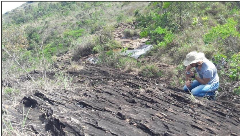
**Figura 1.3:** Coleta de atitudes estruturais utilizando bussola do tipo *Brunton*.
