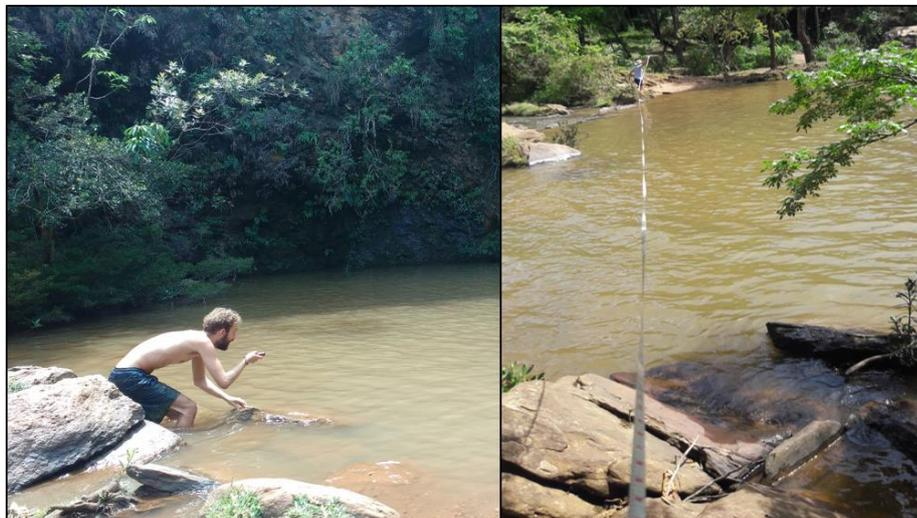
**Figura 1.4:** Utilização de trena a *laser* (a esquerda) e trena manual (a direita) para medição de parâmetros físicos das cachoeiras.
