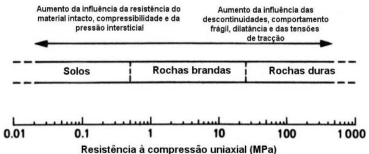
**Figura 3.36:** Espectro geotécnico dos materiais geológicos, demonstrando os limites entre solos, rochas brandas e rochas duras. Retirado de Horta (2019).
