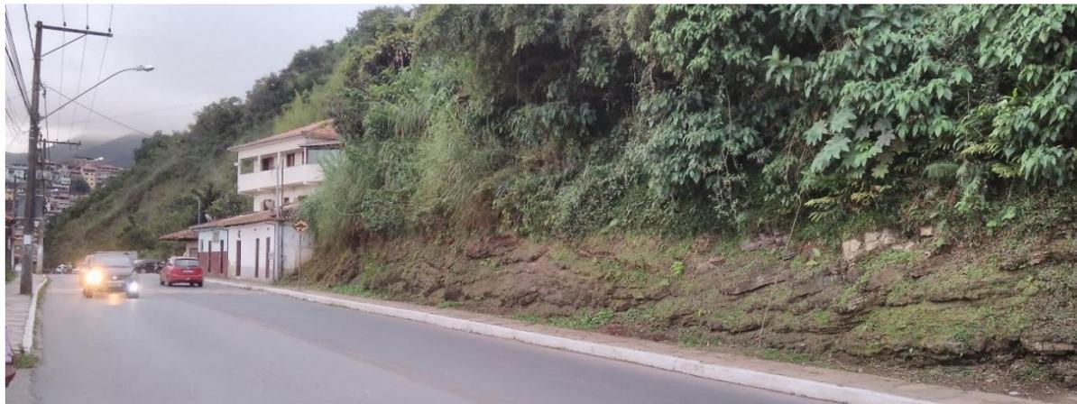
**Figura 3.47:** Foliação do Itabirito da Fm. Cauê com direção de caimento perpendicular ao corte da rua Padre Rolim.
