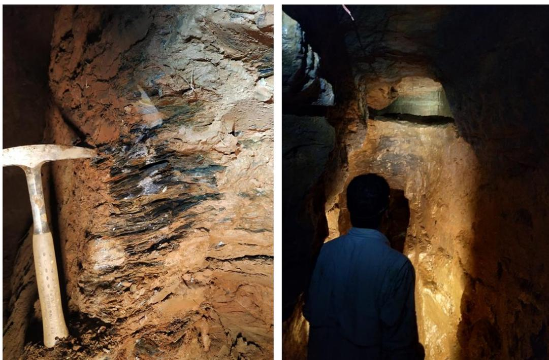
**Figura 3.28:** A galeria se desenvolve estritamente ao longo do filito da Fm. Batatal.
