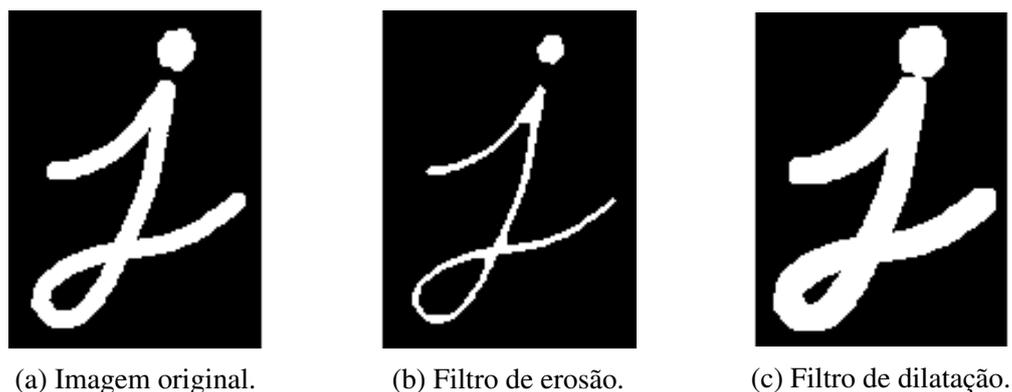
Figura 50 – Operações de erosão e dilatação em uma imagem.
