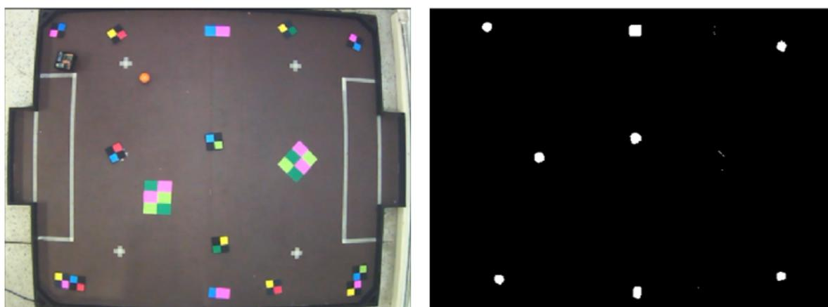
Figura 49 – Aplicação do filtro de *inRange* para detecção da cor azul.
