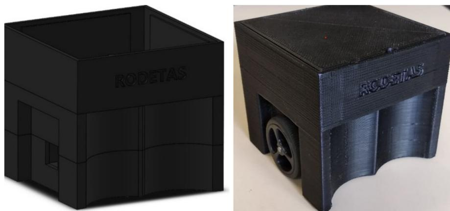
Figura 40 – Modelo projetado e impressão 3D do robô.
