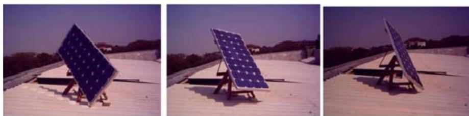
Figura 4 – Sequencia de movimentos de um solar tracker no dia. Fonte: (TESSARO; SOUZA et al., 2006)
