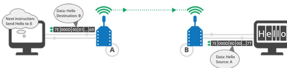
Figura 12 – Frame de uma API do módulo para o computador ou vice-versa . Fonte: (Digi, 2019)
