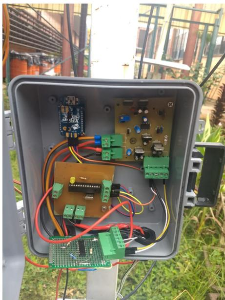
Figura 22 – Sistema no piranômetro contido na caixa hermética. De cima para baixo e da esquerda para a direita: Módulo Xbee, Placa de Alimentação, Placa de Condicionamento de Sinal e Placa de Amplificação do SP-110.
