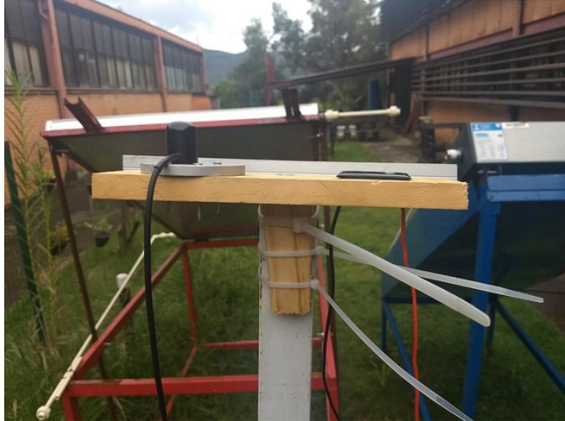
Figura 18 – Montagem de medição do piranômetro.
