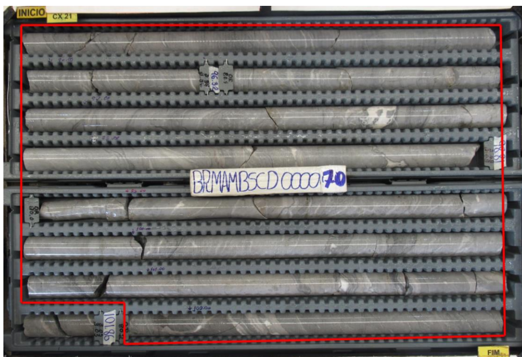
Figura 5.1: Dolomito sem alteração (A1) e pouco fraturado (F2), representando a classe I-A.
