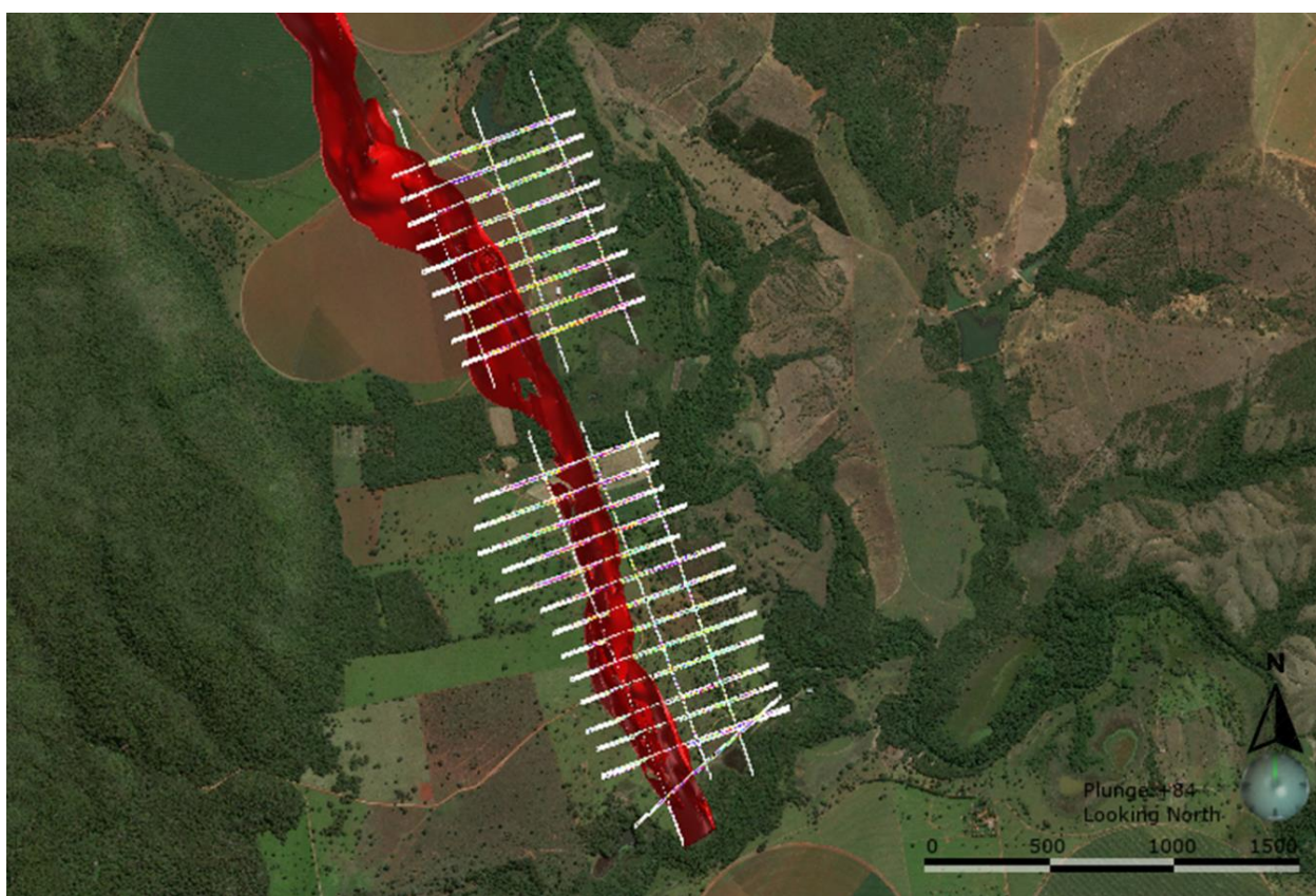
Figura 3.2: Malha de levantamento geofísico ao longo de toda a extensão do corpo.
