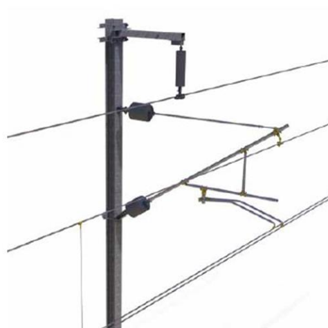
Figure 6: Caténaire V160 STI, 25 kV sur catalogue – SNCF Réseau, 2017 (à gauche)
