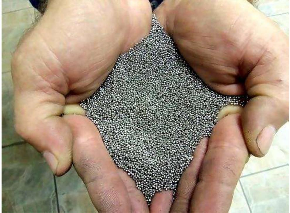
Figura 8 – Granalha de aço
