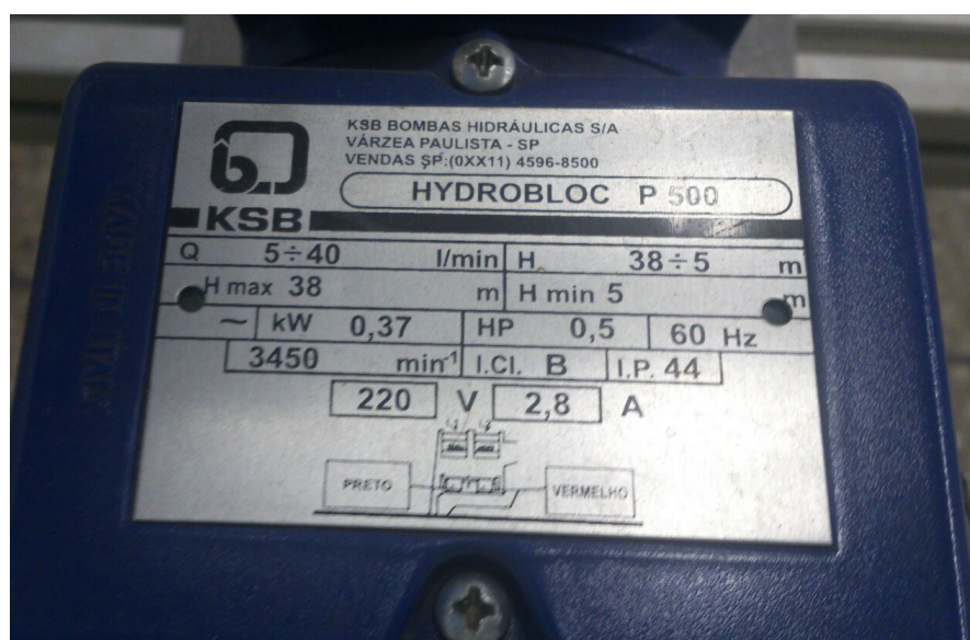
Figura 9 – Especificações da bomba monofásica HYDROBLOC P500
