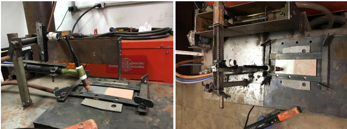
Figura 2.1. Dispositivo de soldagem mecanizada, do Laboratório de Soldagem do Departamento de Engenharia Metalúrgica e de Materiais (DEMET/EM).
