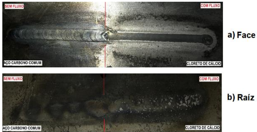
Figura 3.6. Fotografias da (a) face e (b) raiz do cordão obtido. – Amostra de aço estrutural com fluxo \text{CaCl}_2 .
