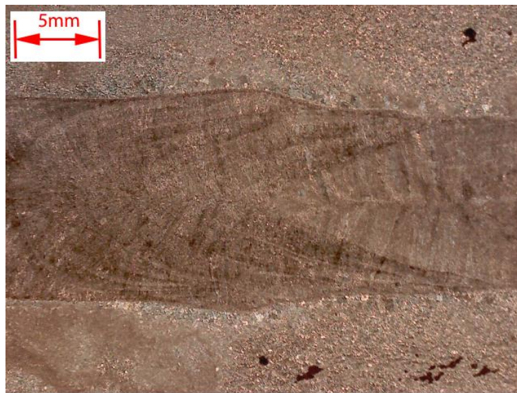
Figura 3.11. Aspecto visual da superfície do cordão de solda obtido com fluxo celulósico: região de transição do processo TIG (à esquerda) para o A-TIG (à direita). Aço inoxidável ABNT 304. Ataque Ácido Oxálico (10%).
