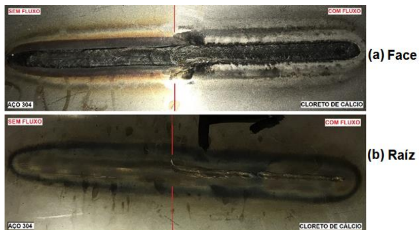
Figura 3.5. Fotografias da (a) face e (b) raiz do cordão obtido. – Amostra de aço inoxidável ABNT 304 com fluxo \text{CaCl}_2 .
