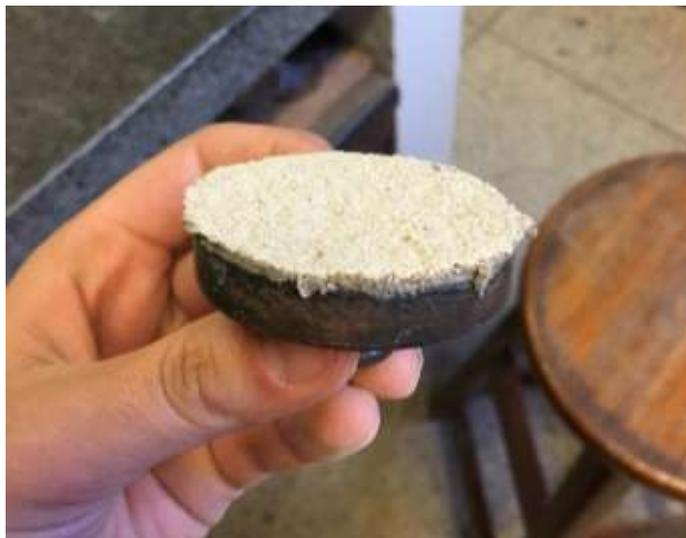
Figura 14 – Pastilha com argamassa rompida após teste de arrancamento
