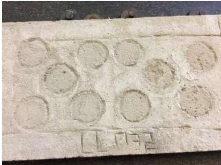
Figura 13 – Placa para teste de arrancamento, moldada conforme normatização
