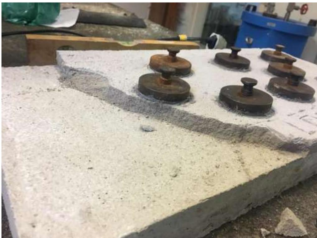
Figura 20 – Teste de arrancamento para zero dias de armazenamento.
