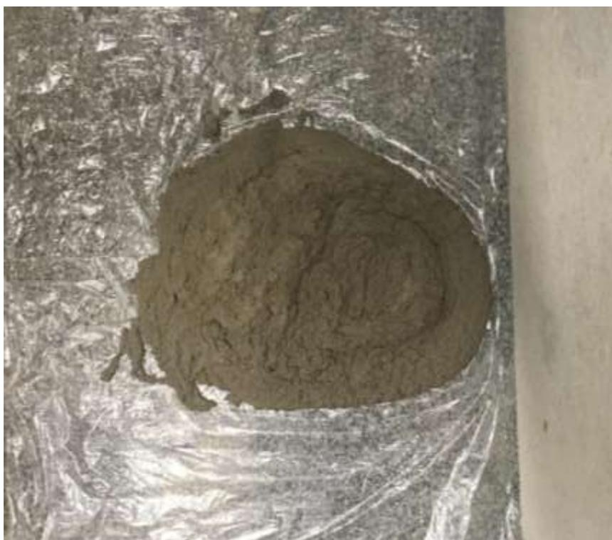
Figura 16 – Teste de espalhamento para armazenamento zero dias de armazenamento
