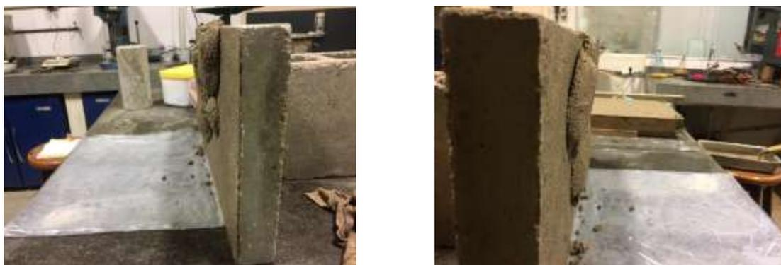
Figura 10 – Teste de rebote para mistura semipronta armazenada por 180 dias e 4,5% de umidade, com 0,5% de LAS.
