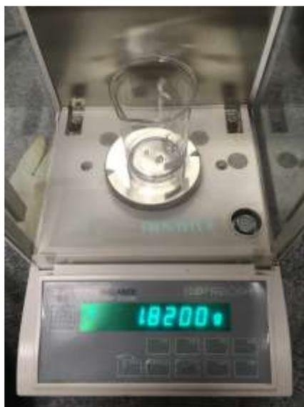
Figura 4 – medição de 0,5% de LAS em relação à massa do cimento em balança de precisão
