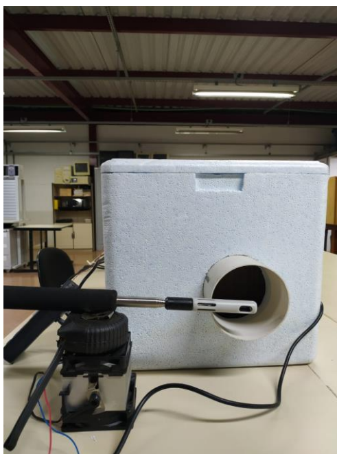
Figura 22: Resfriador evaporativo em funcionamento (vista frontal).
