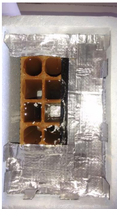
Figura 19: Vedação da área não ocupada pelo tijolo.
