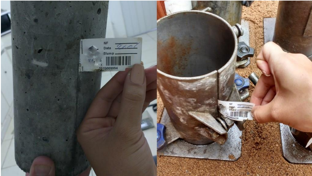
Figura 8 Identificação do corpo de prova Fonte: Elaborado pela autora
