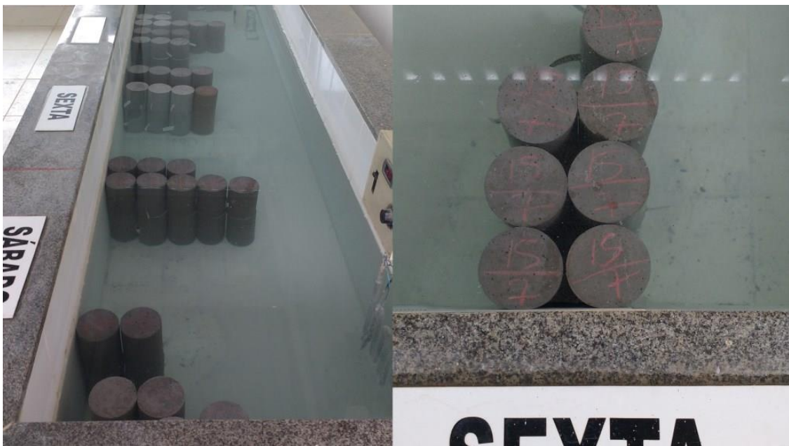
Figura 9 Tratamento do corpo de prova Fonte: Elaborado pela autora
