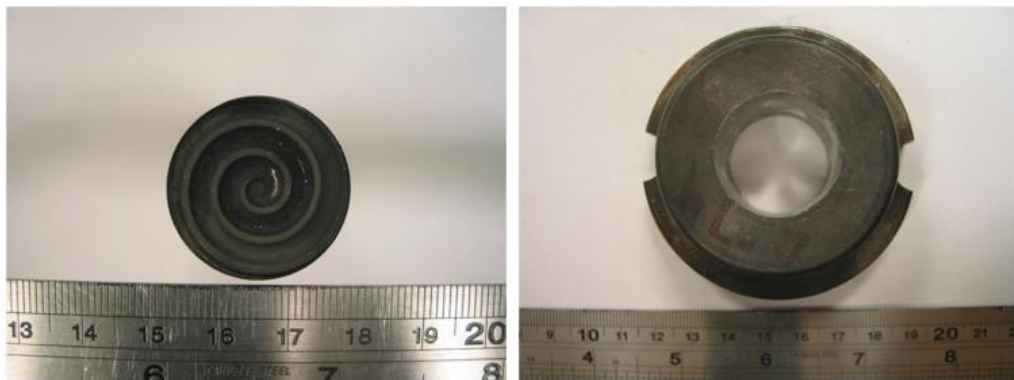
Figura 31. Geometrie di utensile proposte da Li, Baffari e Reynolds
