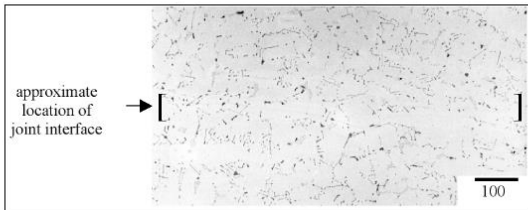
Figura 34. Qualità della giunzione ottenuta tramite Solid Bonding
