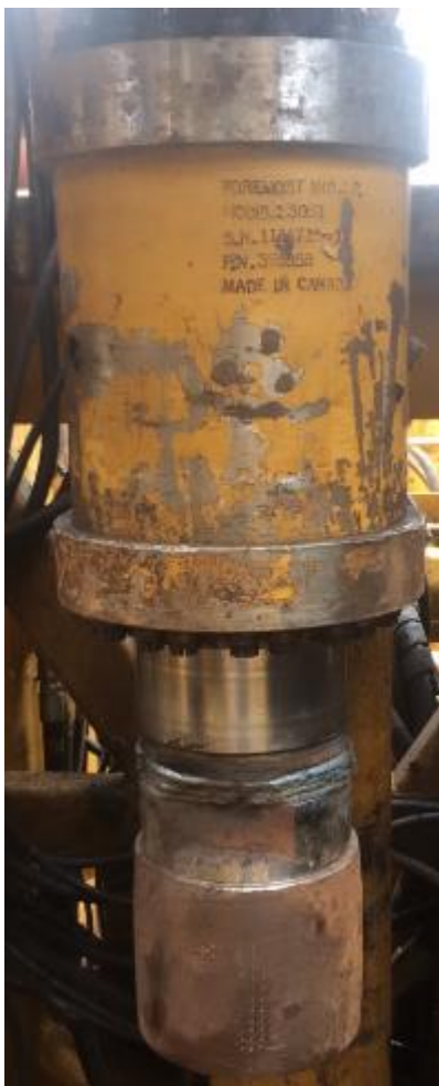
Figura 12: TOPSUB acoplado com amortecedor de choque. Fonte: Pesquisa direta(2019).
