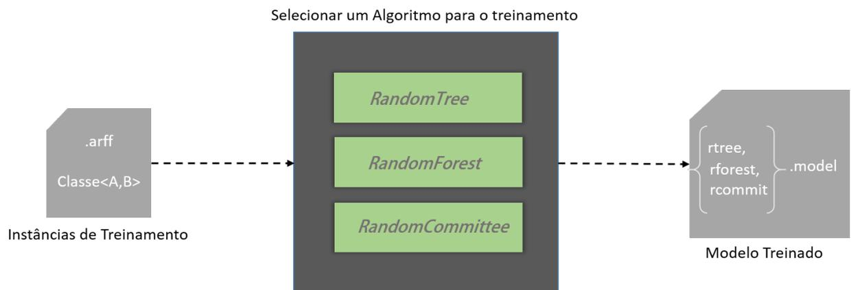
Figura 8: Fluxo de execução do módulo de treinamento
