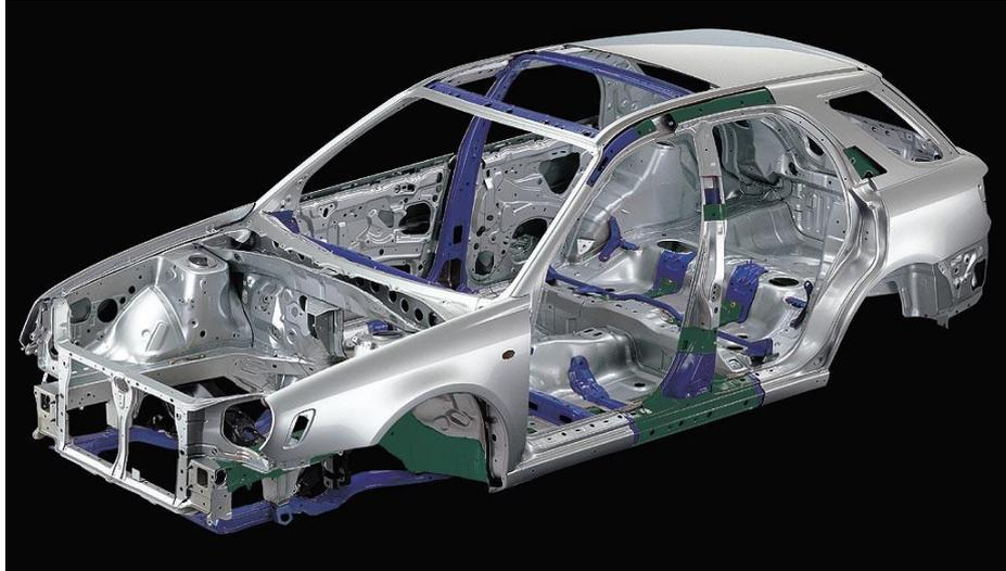
Figura 4: Estrutura Monobloco (Subaru Impreza Wagon)
