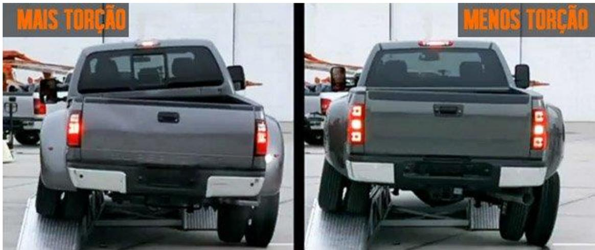
Figura 17: Rigidez Torcional em veículos submetidos a apoios cruzados e desiguais.
