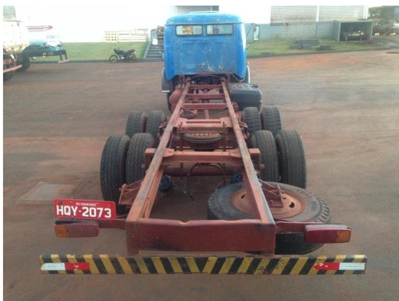
Figura 1: Chassi do Caminhão Mercedes-Benz L113.
