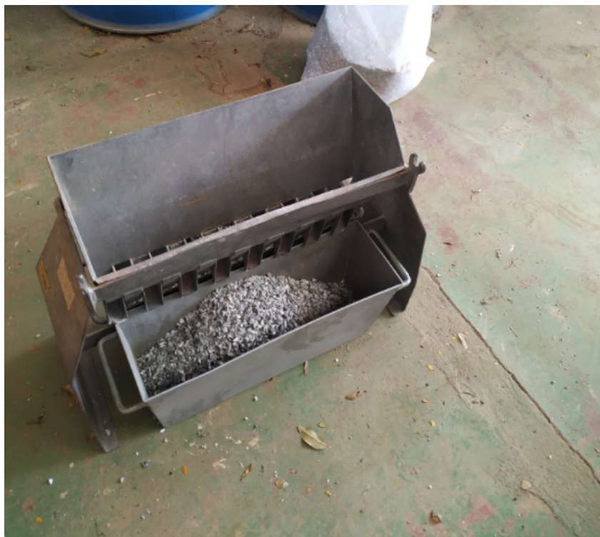
Figura 13 – Quarteador Jones utilizado no teste
