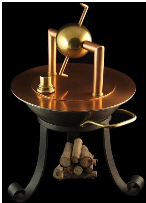
Figura 6 - "Aeolipilo" de Hero. Fonte: BENTLEY, 2007; SCIENCE SOURCE, 2019.
