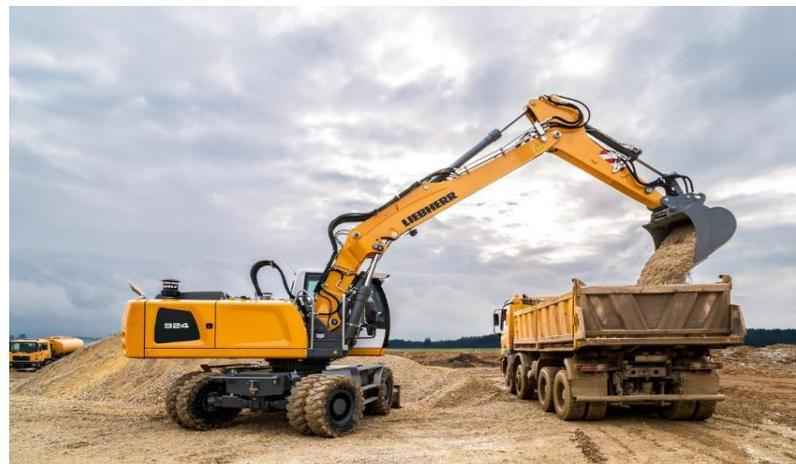
*Figura 5 - Retroescavadeira hidráulica sobre rodas*
