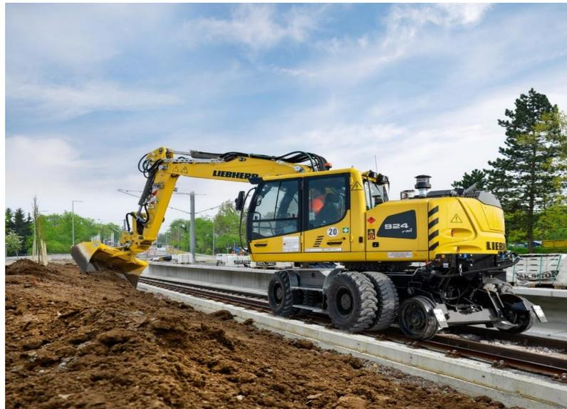
*Figura 4 - Retroescavadeira hidráulica adaptada sobre trilhos*
