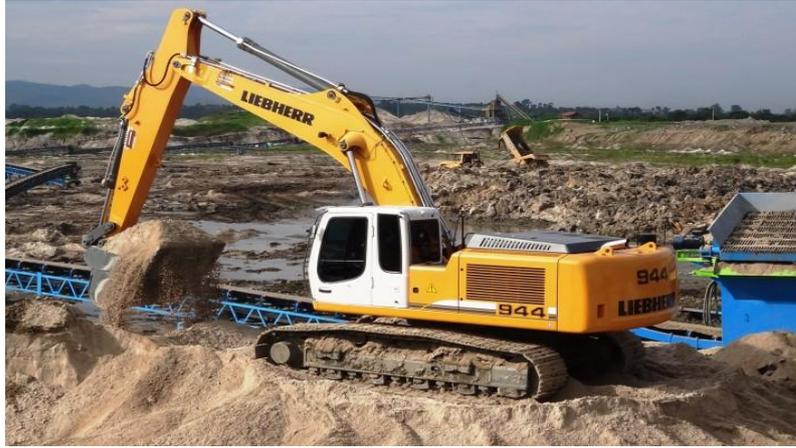
*Figura 3 - Retroescavadeira hidráulica sobre esteiras*
