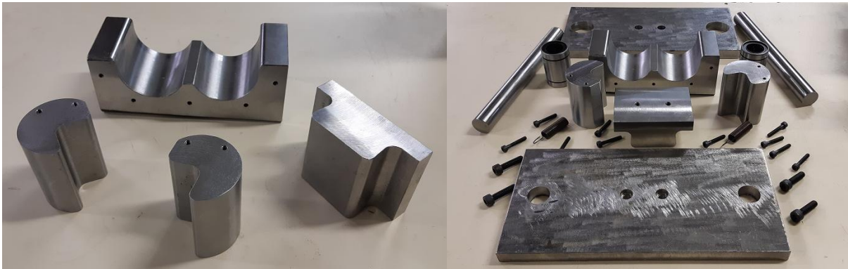
Figura 43 - Base, punção e roletes (esquerda) placas, eixos e rolamentos (direita)
