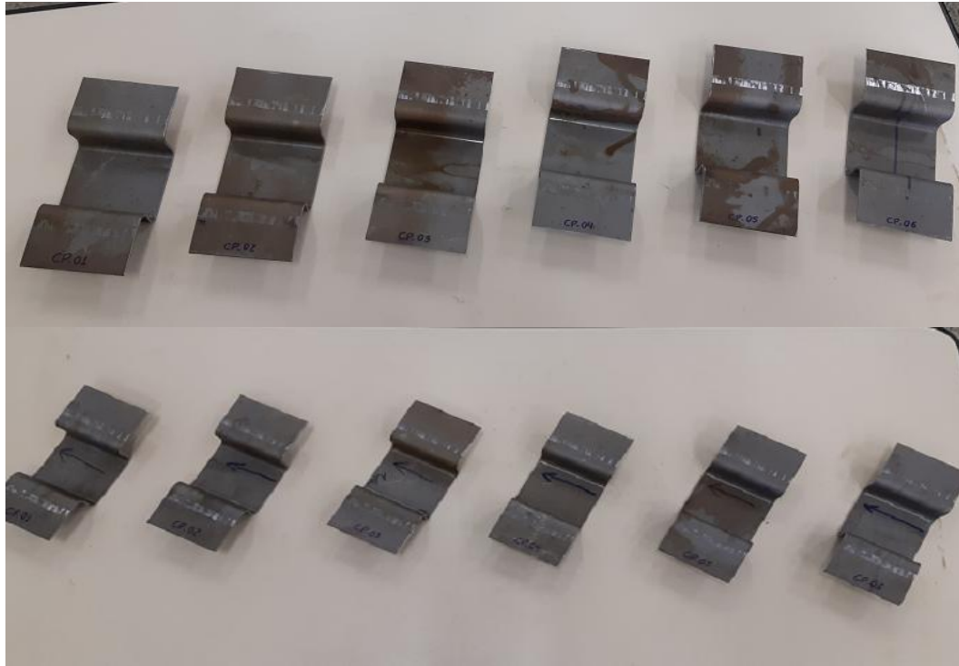
Figura 50 - Perfis dobrados no sentido de laminação (inferior) sentido perpendicular (superior)
