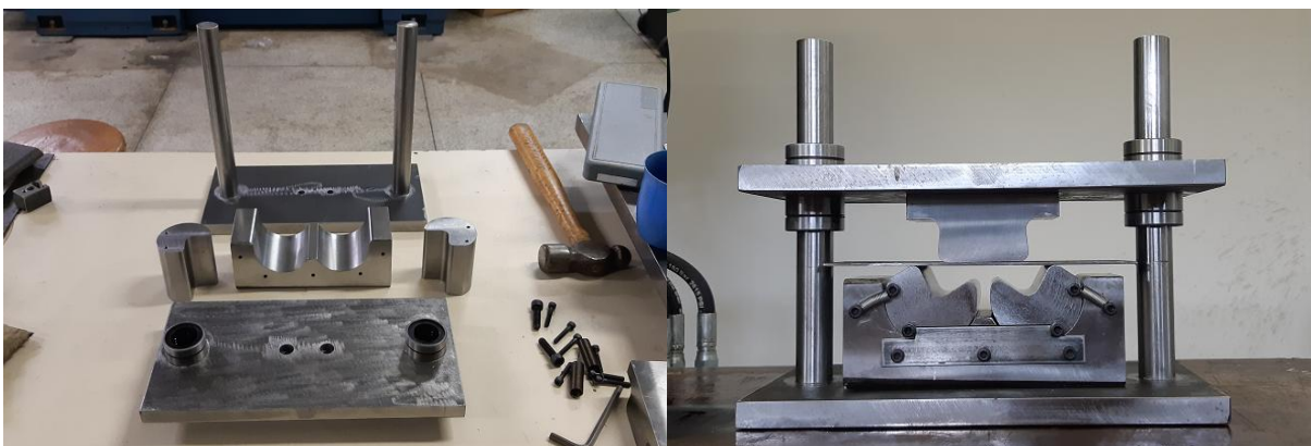
Figura 44 - Início da montagem da matriz (esquerda) - Término da montagem (direita)
