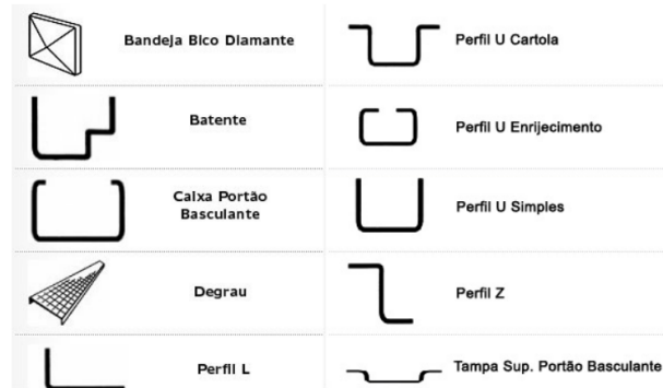
Figura 10 - Perfis passíveis de serem fabricados por dobramento
