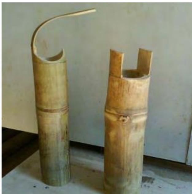
Figura 05. Corte tipo boca de peixe e reto para encaixe.
