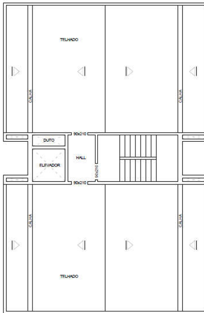
Figura 14 – Cobertura e piso da casa de máquinas (Fonte: Autor)
