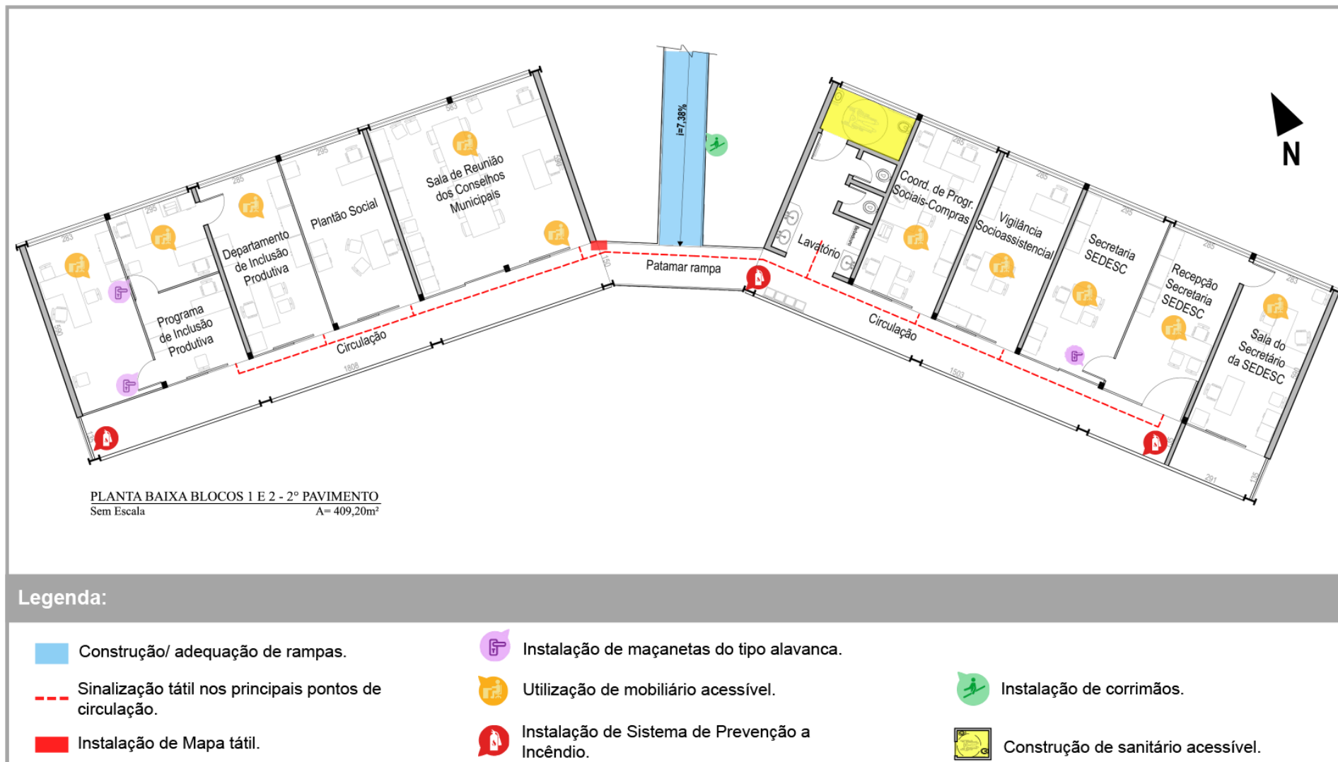
Figura 175: Propostas de adequação para o Segundo Pavimento do edifício sede da SEDESC. Fonte: Elaborado pela autora com base em projeto cedido pela Secretaria de Obras de Mariana.
