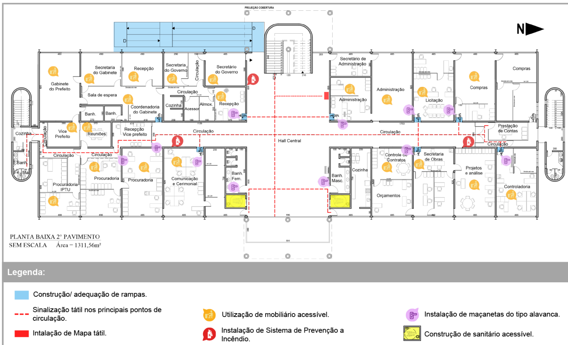
Figura 172: Propostas de adequação para o Segundo Pavimento do edifício sede da Prefeitura. Fonte: Elaborado pela autora com base em projeto cedido pela Secretaria de Obras de Mariana.
