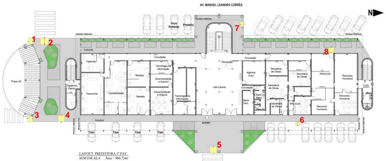
Figura 42: Localização dos rebaixamentos do meio fio com rampas (em amarelo). Fonte: Adaptado pela autora com base em Projeto cedido pela Secretaria de Obras de Mariana.
