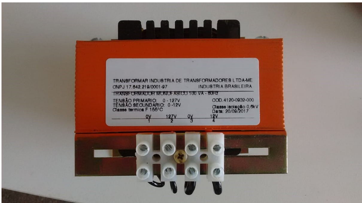
Figura 36 – Transformador utilizado para conectar o conversor à rede.
