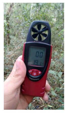
Figura 11: Anemômetro digital INSTRUTEMPO, modelo: ITAN 700
