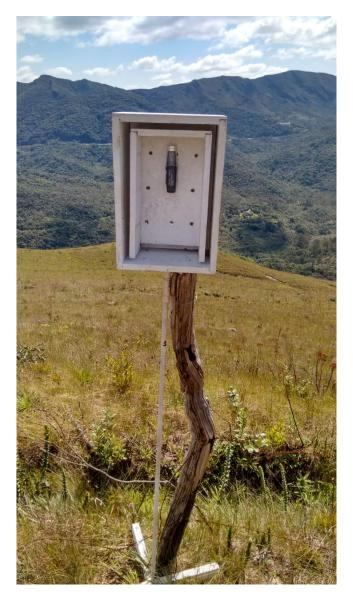
Figura 8: Abrigo meteorológico na área de Campo da EET
