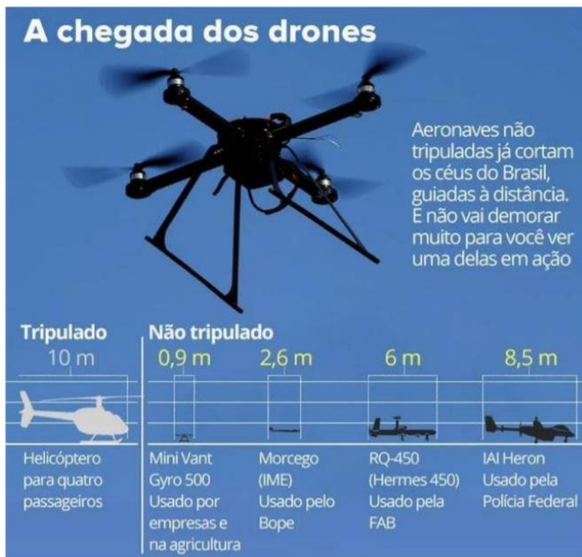
Figura 13 - Comparação entre drones e aeronaves tripuladas e apresentação de diferentes modelos de drones (FEITAL, 2017).
