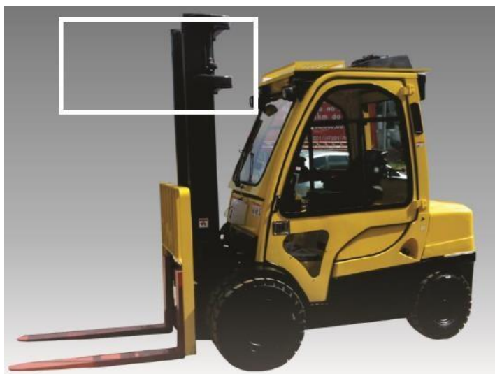
Figura 4: Estrutura da empilhadeira em que foram instalados as TAG’s Fonte: Claus (2018)
