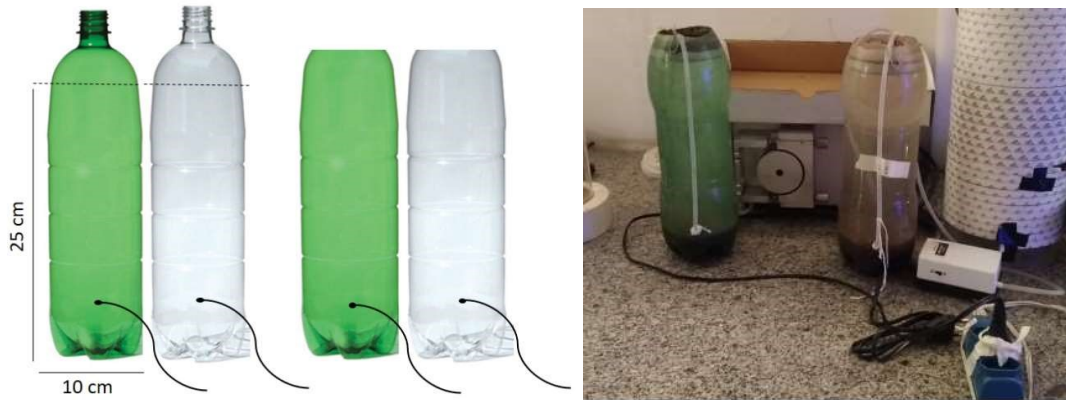
Figura 6- Configuração do reator nos testes preliminares
