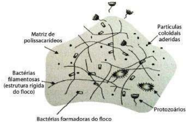
Figura 4- Estrutura típica de um floco de lodo ativado
