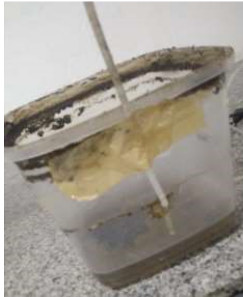
Figura 10 - Perda do volume e lodo do teste preliminar
