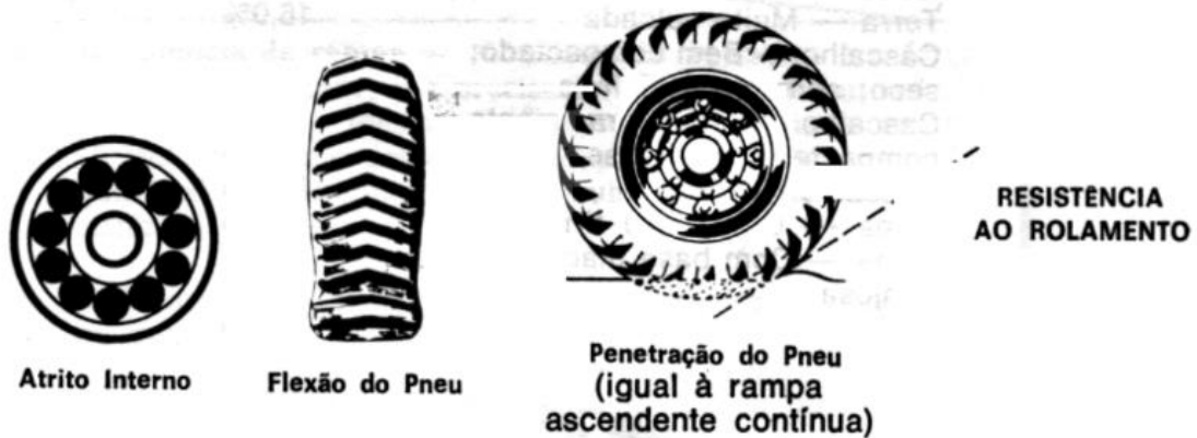
Figure 26 - Efeitos causados aos pneus devido à resistência de rolamento
