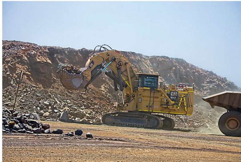
Figure 12 - Escavadeira Hidráulica Shovel Caterpillar 6060B
