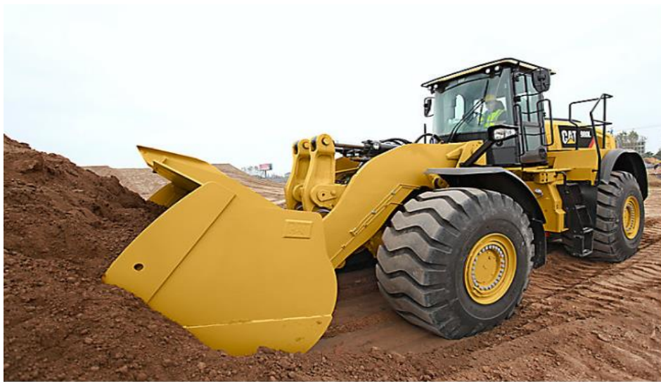
Figure 8 - Carregadeira sobre pneus Caterpillar 980L
