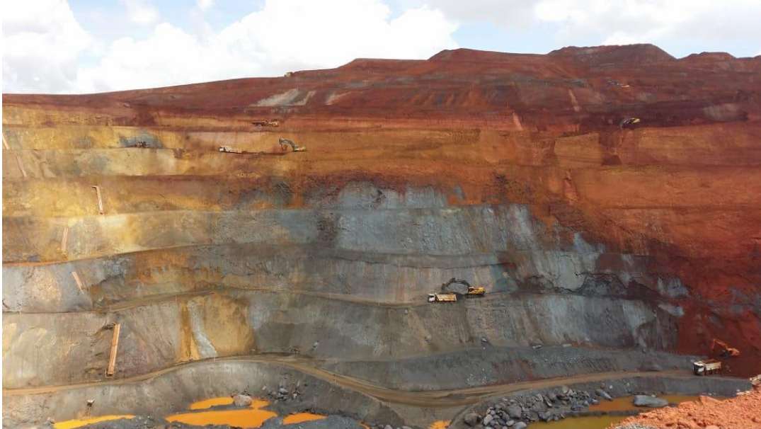
Figure 1 - Lavra de minério de ferro pelo método de bancadas em encosta
