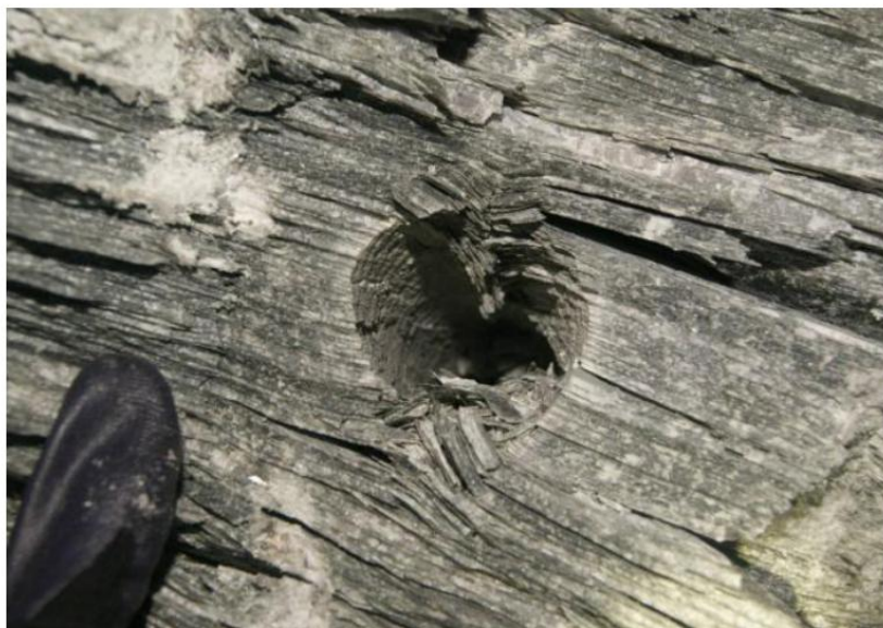
Figura 17 - Flexão em uma Rocha Foliada na mina Cuiabá
