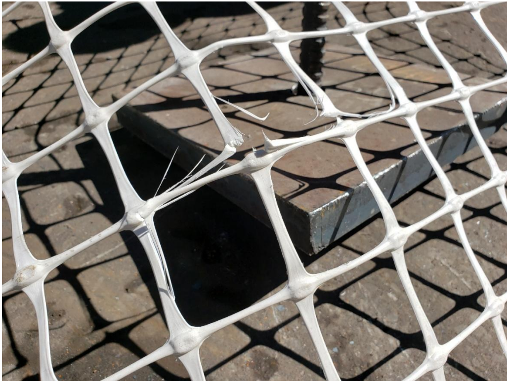
Figura 35 - Ruptura entre a tela e a chapa central de carregamento
