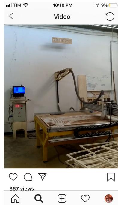
Figura 24: fábrica digital Jangada, em Belo Horizonte. A mesa foi construída pelos próprios donos através da obtenção das plantas na lógica de equipamentos do-it-yourself: versões manufaturadas de equipamentos sofisticados de fabricação, mais caros. Essa prática barateia o custo da ferramenta e aumenta as chances de controle e manutenção sobre o equipamento controlado por computador. Fonte: Fábrica Jangada/Instagram
