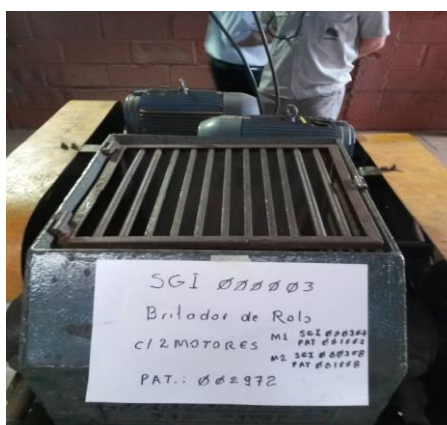
Figura 13: Parte Móvel – Tampa
