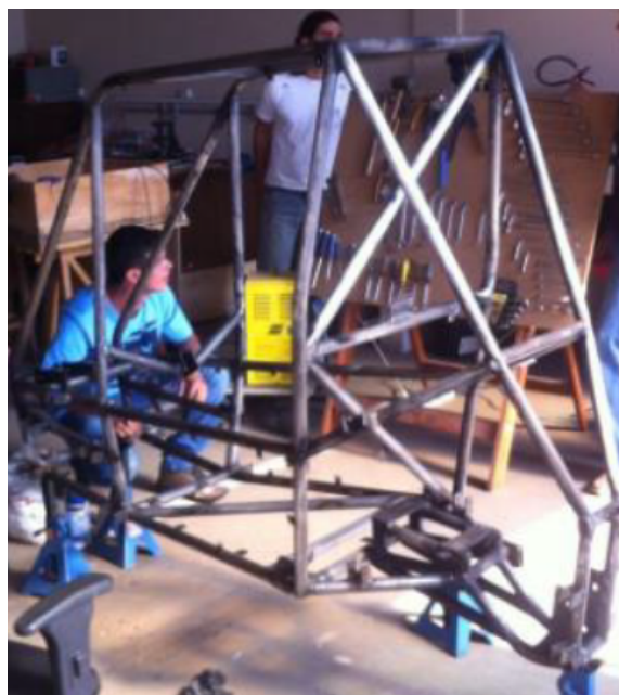
Figura 26: Estrutura tubular protótipo Inconfidentes Baja. Fonte: (INCONFIDENTES BAJA CLUBE, 2017)
