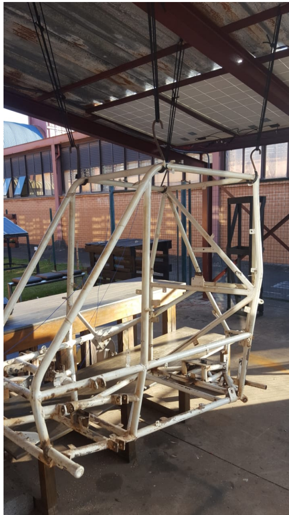
Figura 28: Arranjo para teste de impacto. Fonte: Pesquisa Direta (2019).
