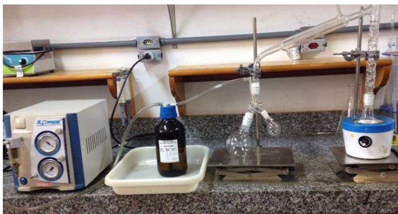
Figura 11 – Sistema utilizado para destilação da anilina.
