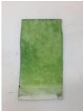
Figura 14 – Filme PVC/PANI obtido por polimerização *in situ*.
