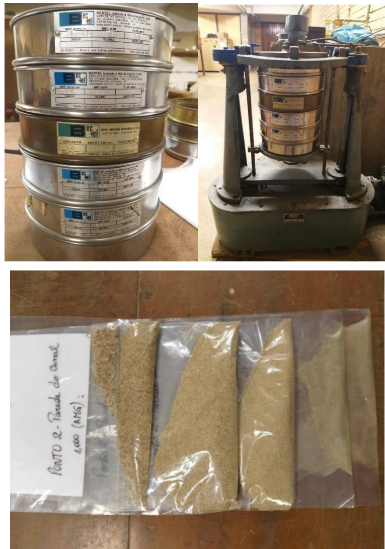
Figura 3 - Equipamentos utilizados para o fracionamento e separação granulométrica dos sedimentos amostrados.
