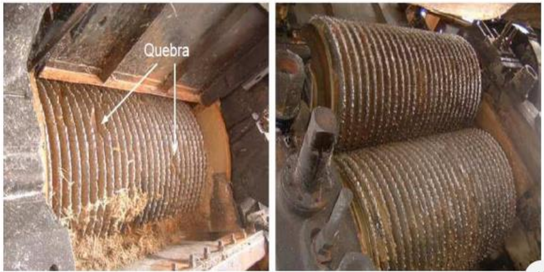
Figura 15 - Moenda em operação e em manutenção Fonte: FEMEC/UFU 2006
